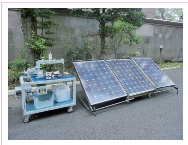
図7 太陽光駆動型マイクロ波光触媒水処理装置の写真
