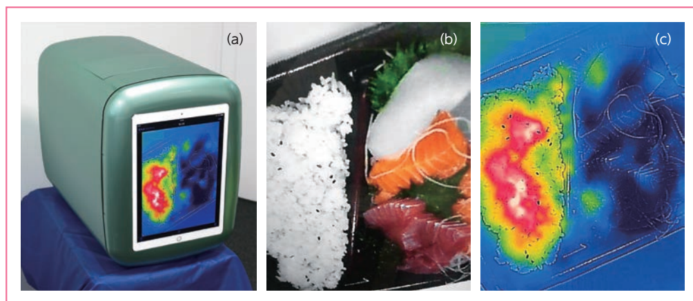
図11 2017年度製インテリジェント電子レンジを用いたお刺身弁当の部分加熱の様子 (a) 外観写真 (b) お刺身弁当 (c) ご飯だけが温まっているサーモグラフィー写真
