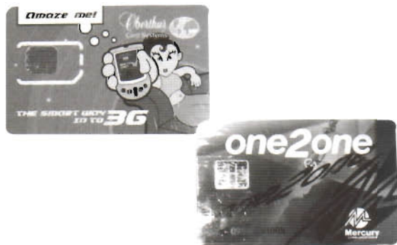
図10 USIM (Universal SIM) カードの例 (左側のIC部分を切り離して携帯機に挿入して使用) 加入者番号、ID、契約情報などの個人情報を記憶
