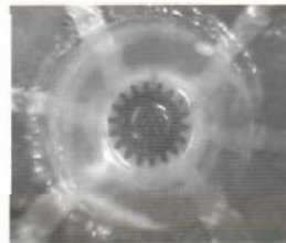
図1 液晶を用いたマイクロモータ (歯車直径: 2.6mm)
