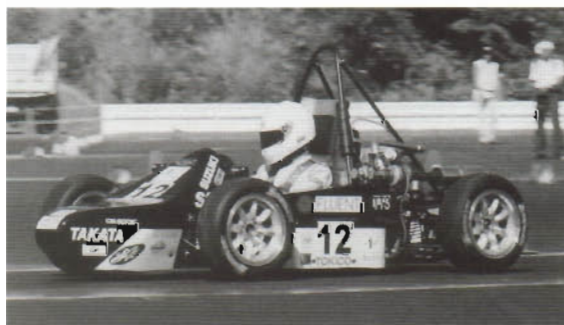
図16 総合2位の国士館大学 軽自動車用エンジンをターボチャージャーにより過給し高トルク・低燃費を実現
