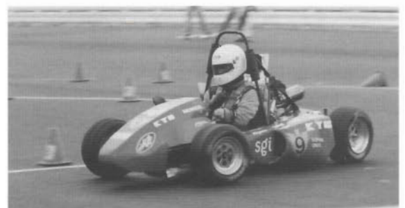
図14 前後に取り付けたアンチロールバーの効果により適度なロール角度で旋回する車両
