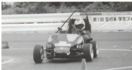
図17 総合3位の東京大学 エンジンとCVTトランスミッションを運転席横に搭載し高い旋回性能を実現
